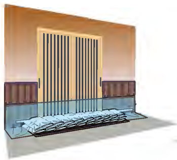
1.8m (1 間) 幅の玄関 3 段積みの場合 水のう袋 約 30 袋 防水シート 幅約 4m ~ 止水クッション 2m
